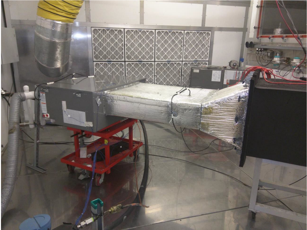
3.5 ton air handler
